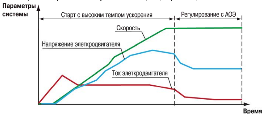
Рисунок 4.2 - Принцип работы оптимизации энергопотребления
