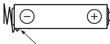
Рисунок В.10b – Оболочка батареи проколота
