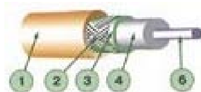
Кабель: 1 – внешняя изоляционная оболочка; 2 – медная оплетка; 3 – изоляция; 4 – оболочка; 5 – токоведущая жила.
